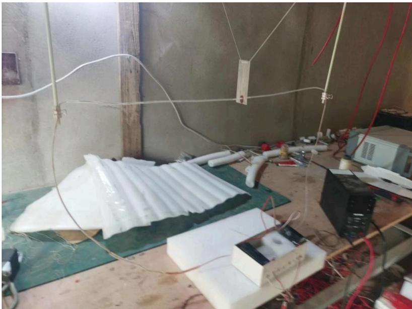
Con un tubo de silicona de 190 cm de largo, diámetro externo de 3 mm [o 2 mm] y diámetro interno de 1 mm, se colocan dos cables de cobre recubierto de pintura de 90 cm de largo y diámetro de 0.8 mm. Los dos cables no se tocan, están separados por 5 cm.
